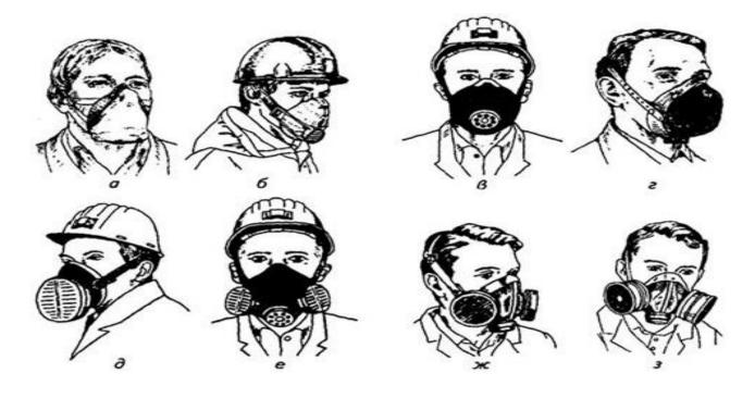
Противопылевые защищают органы дыхания от аэрозолей различных видов, противогазовые от вредных паров и газов, а газопылезащитные от газов, паров и аэрозолей при одновременном их присутствии в воздухе.
